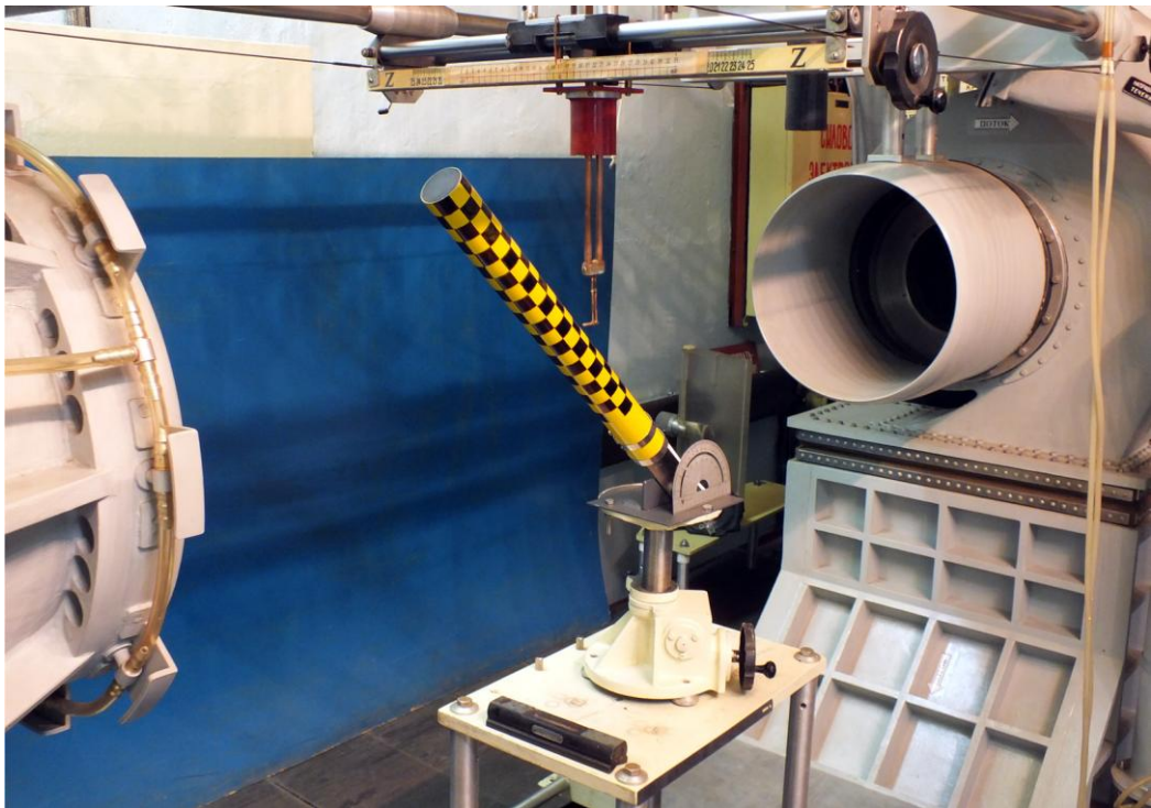
Рис. 2.4. Вид аэродинамической установки при расположении модели звена ПМ под углом Q = 45^\circ к набегающему воздушному потоку
